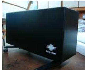
O ensaio, normalizado pela ISO 140 consiste basicamente em excitar a laje, na sala da fonte, com um aparato padronizado de ensaio de impacto, o qual contém cinco pequenos marteleiros de 0,5 Kg cada um, que são liberados em queda livre de uma altura de 4 cm, a uma taxa de dez impactos por segundo.
